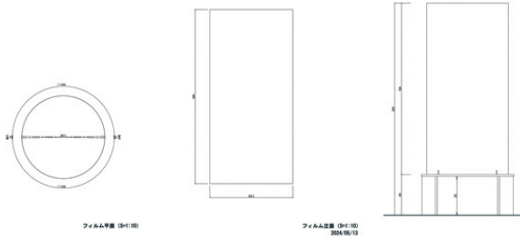
図3：作者の身体寸法でデザインしたタンクの設計図
