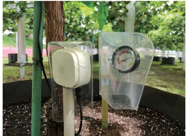
図10：土壌水分計とモニタリング用カメラ
