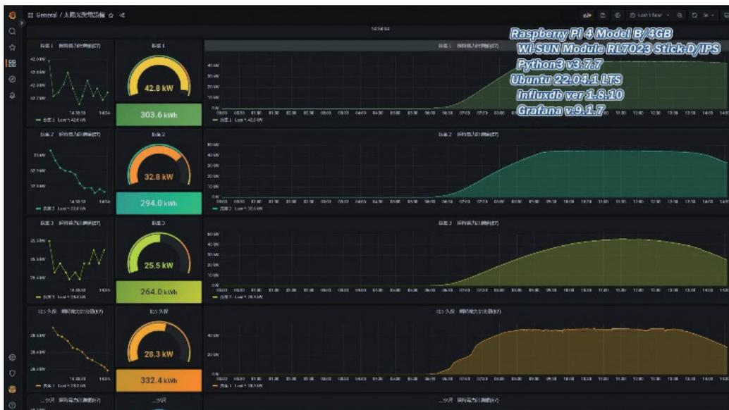
図7：Bルートサービスによる発電状況のモニタリング
